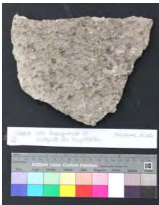
Abb. 423: Scholle 9 Vorzustand (Hirschhornsalz-Paste)
