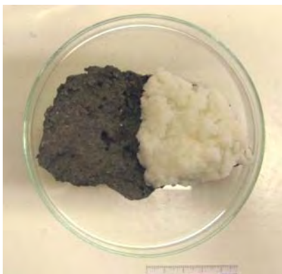
Abb. 374: Probestück mit aufliegender Arbocel-Komresse
