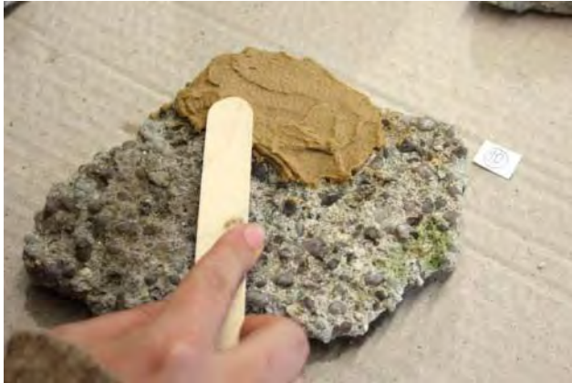
Abb. 426: Scholle 10: Antragen der Ionenaustauscher-Paste
