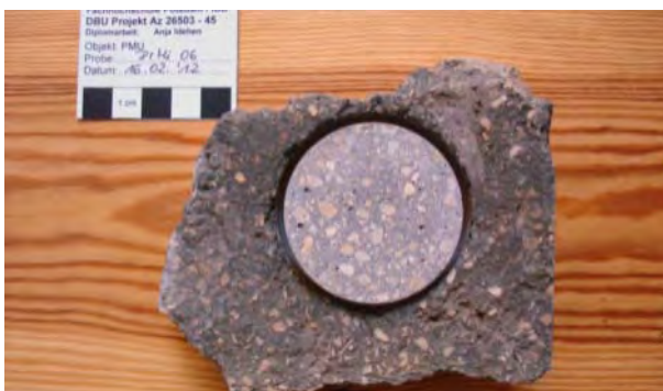
Abb. 563: Vergleich Steinputzmörtelprobe PrMi 06 mit Fragment Bestandsputz (bewitterte Oberfläche).
