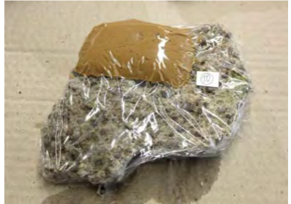
Abb. 427: Scholle 10: angetragene Ionenaustauscher-Paste mit Abdeckung aus PE-Folie
