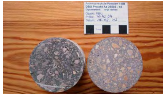
Abb. 560: Bestandsputz (links) und Steinputzmörtelprobe PrMi 04 (rechts)
