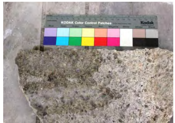
Abb. 433: Scholle 8: schäumender ILKA Bio-Steinreiniger
