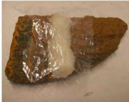
Abb. 386: Ammoniumcarbonat und Komresse mit Folienabdeckung
