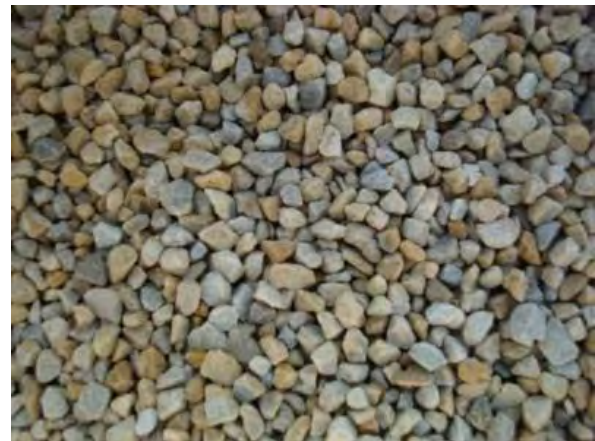
Abb. 525: grobe Dolomitsplittkörnung der „DüKa Düngerkalkgesellschaft mbH“ 2-5mm Dolomitsplitt.
