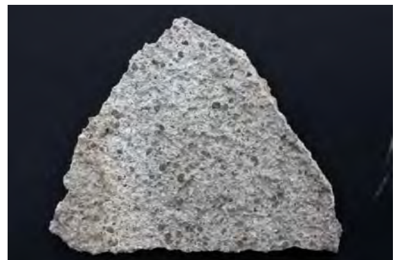
Abb. 435: Scholle 8 Endzustand (ILKA Bio-Steinreiniger)
