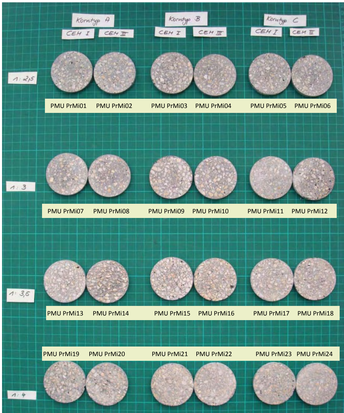
Abb. 548: je 1 zylindrischer Prüfkörper aus 24 Steinputzergänzungsmörtelmischungen
