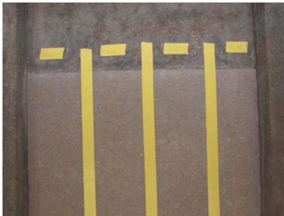
Abb. 518: Absäuerung Ergänzungsputz Typ B
