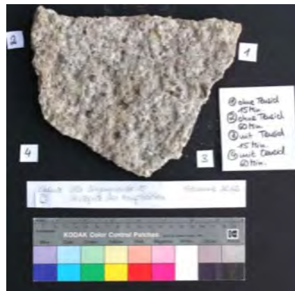
Abb. 424: Scholle 9 erstes Reinigungsergebnis (Hirschhornsalz-Paste)
