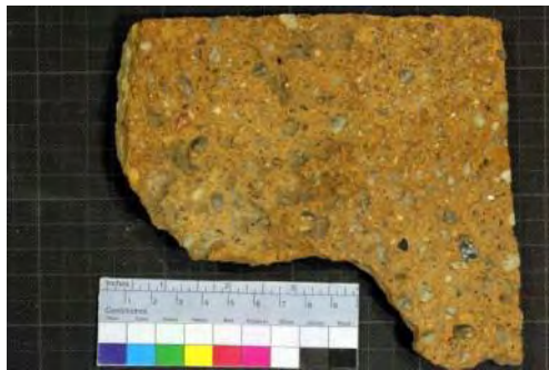
Abb. 244: Probe Amds 01 (Unterputz) und 02 (Kratzputz)
