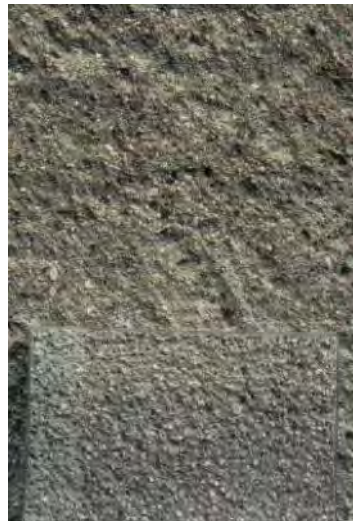
Abb. 365: Kratzputznachstellung Villa Vehse , nachträglich durch Sandstrahlen bearbeitet, um Abwitterung zu simulieren.
