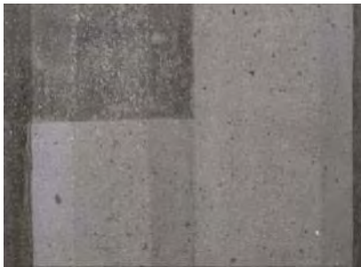
Abb. 509: Typ A mit hellen feinen und großen dunklen Zuschlägen
