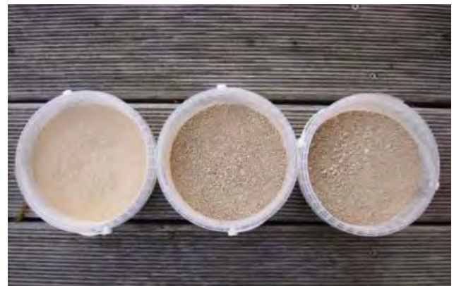
Abb. 523: feinere Dolomitmörnung der „Ostrauer Kalkwerke GmbH“ 0-0,09mm Kalksteinmehl, 0,1-2mm Kalkbrechsand, 0,1-4mm Dolomitgrieß (von rechts nach links).
