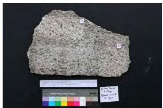
Abb. 420: Scholle 6 Endzustand (Hirschhornsalz-Gel)
