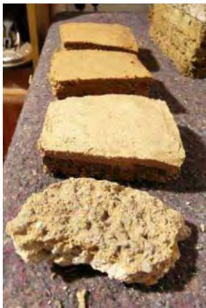
Abb. 457: Ermittlung des Farbtons für den Ergänzungsmörtel; Beprobung auf kleineren Probeplatten; Edelkratzputz Wohnhaus Potsdam und Hufeisensiedlung
