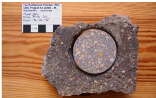
Abb. 553: Optischer Vergleich der Steinputzmörtelprobe PrMi 01 (zylindrischer Probekörper) mit Fragment des Bestandsputzes (bewitterte Oberfläche).
