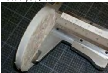
Abb. 545: Kontrolle der Höhe der Probekörper. Höhe = 0,5cm.
