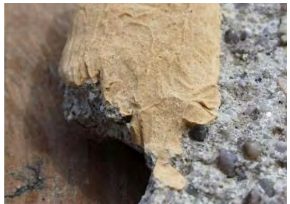
Abb. 429: Scholle 10: durchgetrocknete Ionenaustauscher-Paste
