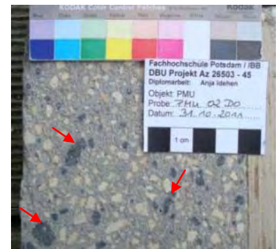
Abb. 528: Pigmentanreicherung, erste Probereihe, PrMi PMU 02 DO.
