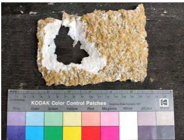
Abb. 440: abgetrocknetes Hirschhornsalz-Gel nach Abnahme mit verbleibenden Putzresten
