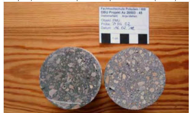
Abb. 556: Bestandsputz (links) und Steinputzmörtelprobe PrMi 02 (rechts)
