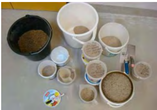
Abb. 529: Mischen der versch. Korngrößen
