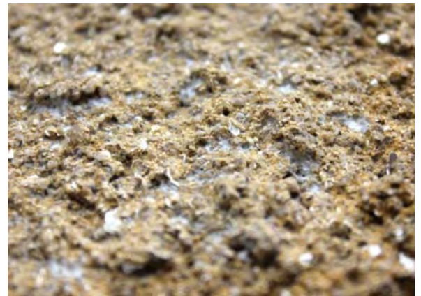
Abb. 439: Hirschhornsalz-Gel –Rückstände auf Probefläche nach Reinigung
