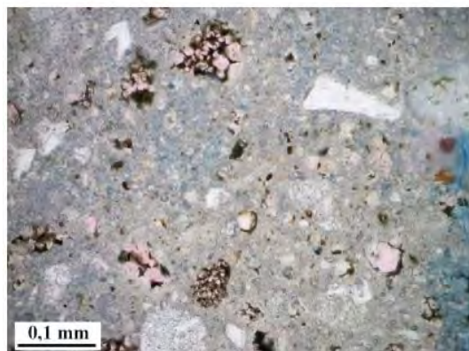
Abb. 292: DS Steinputz, karbonatisiert: PZ-Klinker, gefärbt (Phenolphthalein?); DL //N
