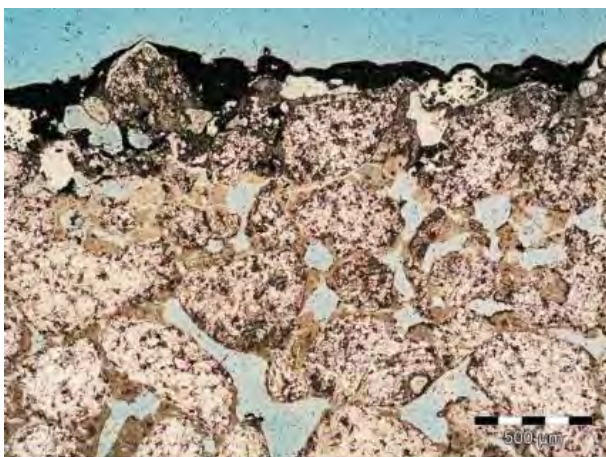
Abb. 174: Si 01, Dünnschliffphoto (Ilpol) weißer Edelputz mit Oberfläche (Anstrich)
