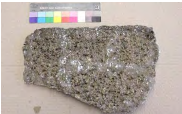
Abb. 415: Scholle 6: angetragenes wässriges-neutrales Gel
