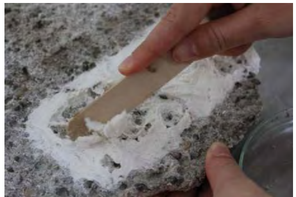
Abb. 418: Scholle 6: Abnahme des Hirschhornsalz-Gels
