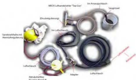
Abb. 346: Überblick über Technik des Injektorstrahlverfahrens
