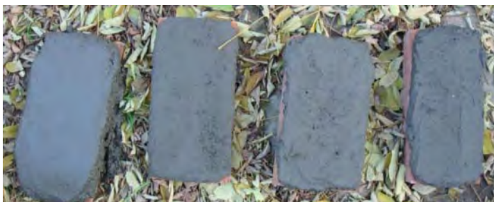
Abb. 536: Steinputzprobemischungen auf mobilen Putzträgern (Ziegeln). Zusammensetzung analog der an die Wand aufgetragenen Mörtel.
