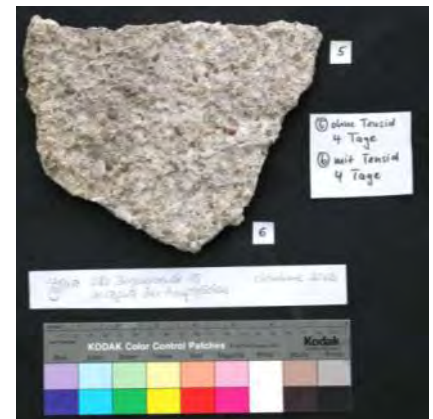
Abb. 425: Scholle 9 Endzustand (Hirschhornsalz-Paste)
