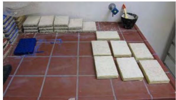
Abb. 444: Vorbereitete Platten mit Unterputz
