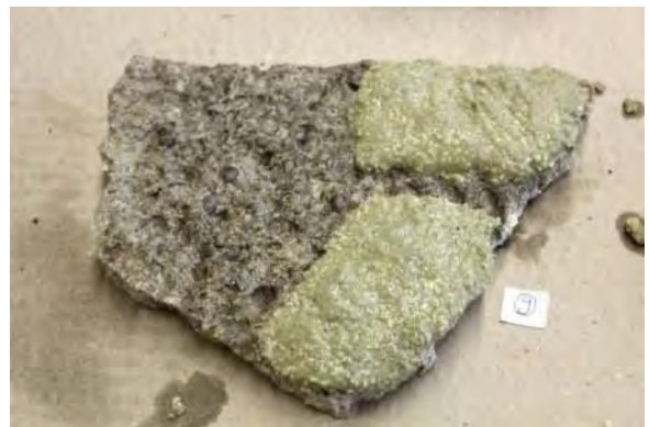
Abb. 422: Scholle 9: angetragene Hirschhornsalz-Paste
