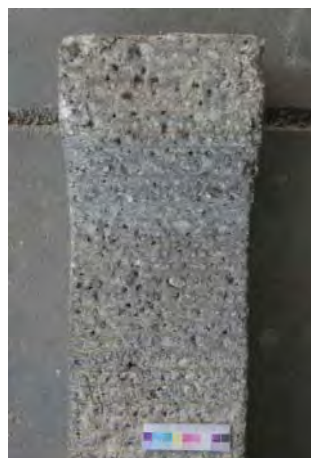
Abb. 380: Nachzustand, Reinigung mit Glaspudermehl, fein
