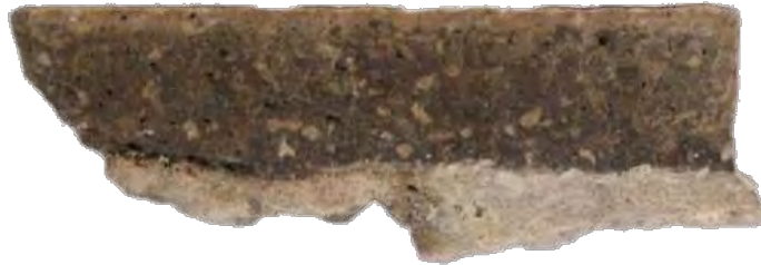
Abb. 498: Probe PMu 08, Querschnitt; unten Unterputz, oben Oberputz mit deutlich ockerfarben oxidierte Schicht
