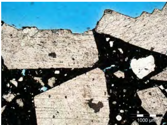
Abb. 286: WS 05, DS (Ilpol), Putzstruktur an der Oberfläche, hier mit großen Calcitzuschlägen und wenigen kleinen gerundeten Quarzen
