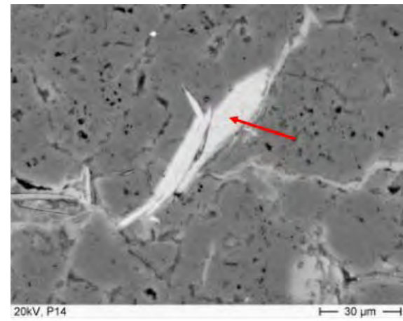
Abb. 321: PMu 14, Dolomitm Korn mit Calcit in Rissen und Kalifeldspat-Korn (helles Korn, unten). Der helle, leistenförmige Einschluss (roter Pfeil) ist ein FE-reiches Tonmineral.
