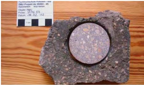
Abb. 559: Vergleich Steinputzmörtelprobe PrMi 04 mit Fragment Bestandsputz (bewitterte Oberfläche).
