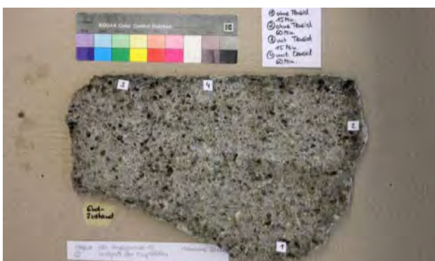
Abb. 419: Scholle 6 erstes Reinigungsergebnis (Hirschhornsalz-Gel)
