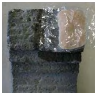
Abb. 377: Ionenaustauscherharz, Auflage abgedeckt mit Hostaphanfolie
