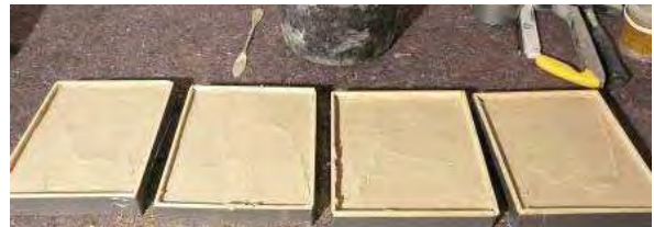
Abb. 456: Probeplatten mit Unterputz
