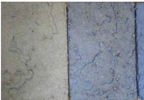
Abb. 448: Probeplatten B1 und B2 mit typischer Madenstruktur in noch frischem Zustand
