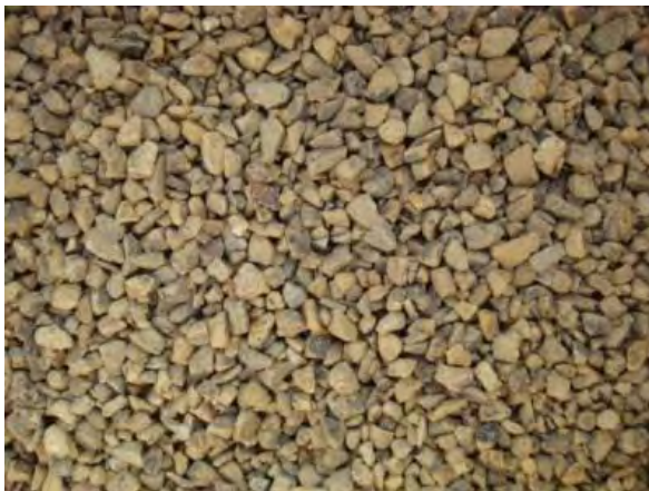
Abb. 524: grobe Dolomitsplittkörnung der „Ostrauer Kalkwerke GmbH“ 2-5mm Dolomitsplitt.
