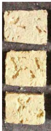
Abb. 457: Ermittlung des Farbtons für den Ergänzungsmörtel; Beprobung auf kleineren Probeplatten; Edelkratzputz Wohnhaus Potsdam und Hufeisensiedlung
