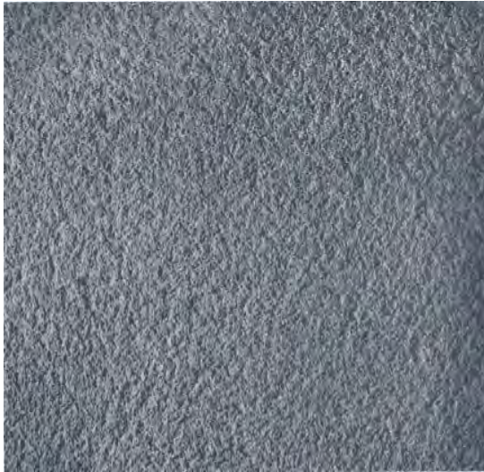
Abb. 66: Terranova - feinkörniger Kratzputz
