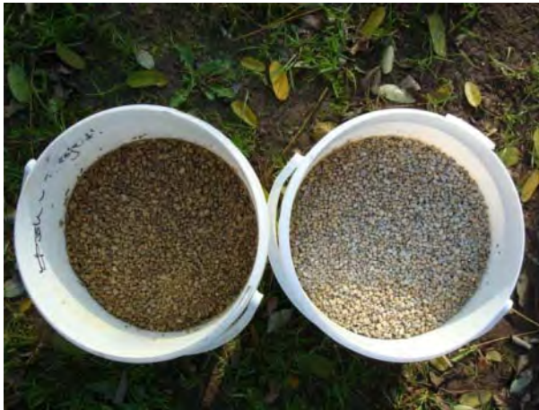
Abb. 534: Dolomitsplitt aus Ostrau (links) und Dolomitsplitt aus Barbingen (rechts).
