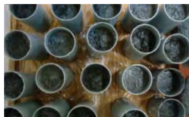
Abb. 543: Rohrabchnitte, gefüllt mit Steinputz-Probemischungen
