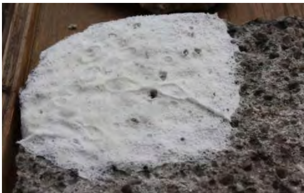
Abb. 417: Scholle 6: abgetrocknetes Hirschhornsalz-Gel
