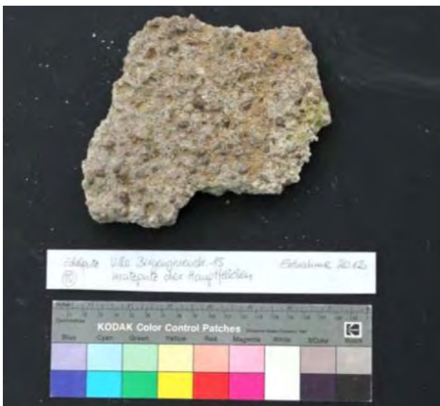
Abb. 430: Scholle 10 Vorzustand (Ionenaustauscher-Paste)
