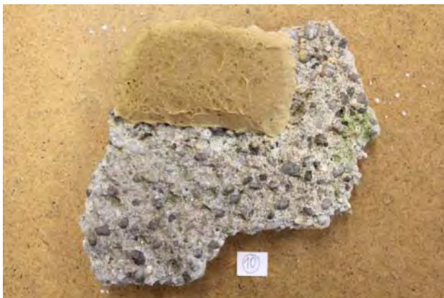
Abb. 428: Scholle 10: halb durchgetrocknete Ionenaustauscher-Paste
