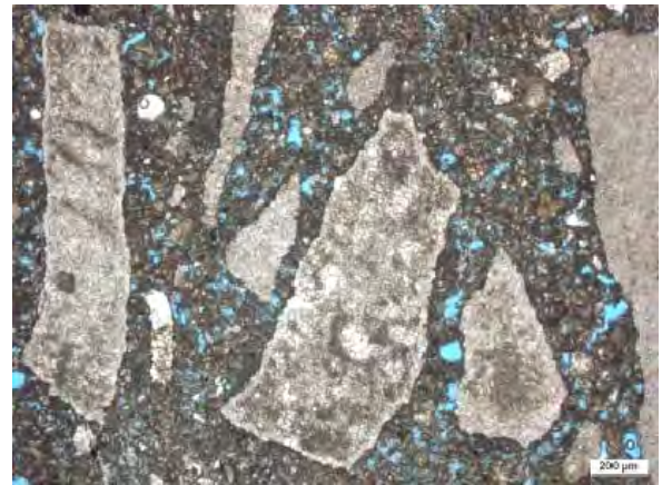
Abb. 307: PMu 14, Gefüge mit Dolomitmörnern. Typisch für den Dolomit-Splitt sind die kantigen Bruchformen. Die bräunlichen Domänen in den Körnern werden durch FeOxid-reiche Tonminerale hervorgerufen. [PolMi-Aufnahme, I Pol.]
