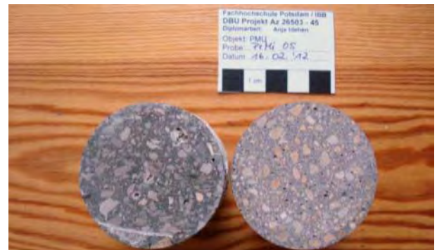
Abb. 562: Bestandsputz (links) und Steinputzmörtelprobe PrMi 05 (rechts)
