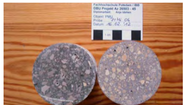
Abb. 564: Bestandsputz (links) und Steinputzmörtelprobe PrMi 06 (rechts)
